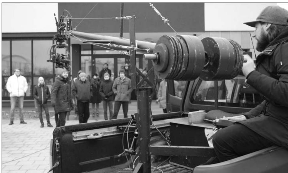
Zajímavým bodem doprovodného programu byla prezentace kamerového jeřábu umístěného na korbě terénního Nissanu Navara. Specialisté na vizuální efekty ze společnosti 3heads production toto zařízení vlastní konstrukce užívají k pořizování akčních záběrů foto/mj
